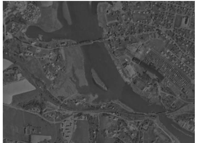
1956 Normal vannstand men med tydelig avleiring fra nord etter at Sagelva har endret løp
