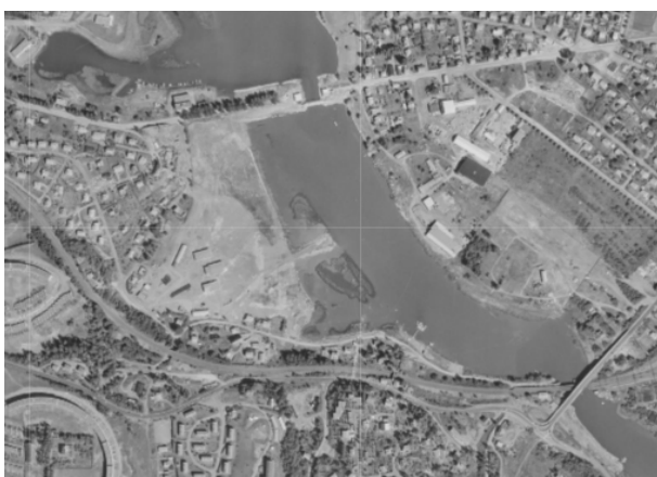
1975 Den naturlige «tungen» fra nord er rettet ut ved utfylling av sprengstein og andre masser
